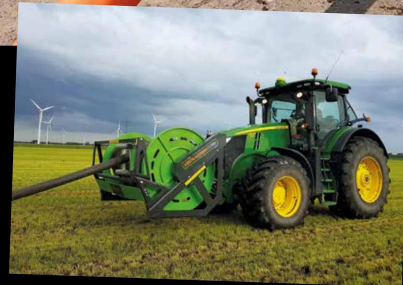
Ob mit Wickelhilfe oder Überschlagbügel, mit einem oder zwei Hydraulikmotoren – die Haspel unterstützt bei jedem Einsatz.
