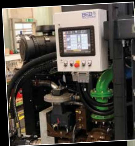
Hydraulische Pumpstation mit Zapfwellenantrieb. Ein Dieselmotor ist ohne weitere Umbauten nachrüstbar.
