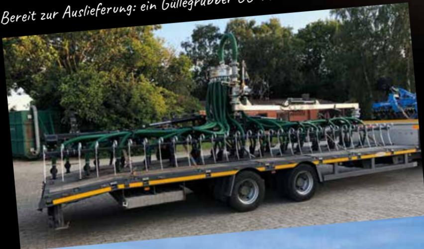
Gülleverschlauchung auf Weizen im Frühjahr: Güllecontainer mit Pumpstation (vorne montiert) und Bomech Farmer 15 Schleppschuhgestänge. Außerdem: Nutzung des PROFI ZS PU102 Ziehschlauch in transluzentem Grün.
