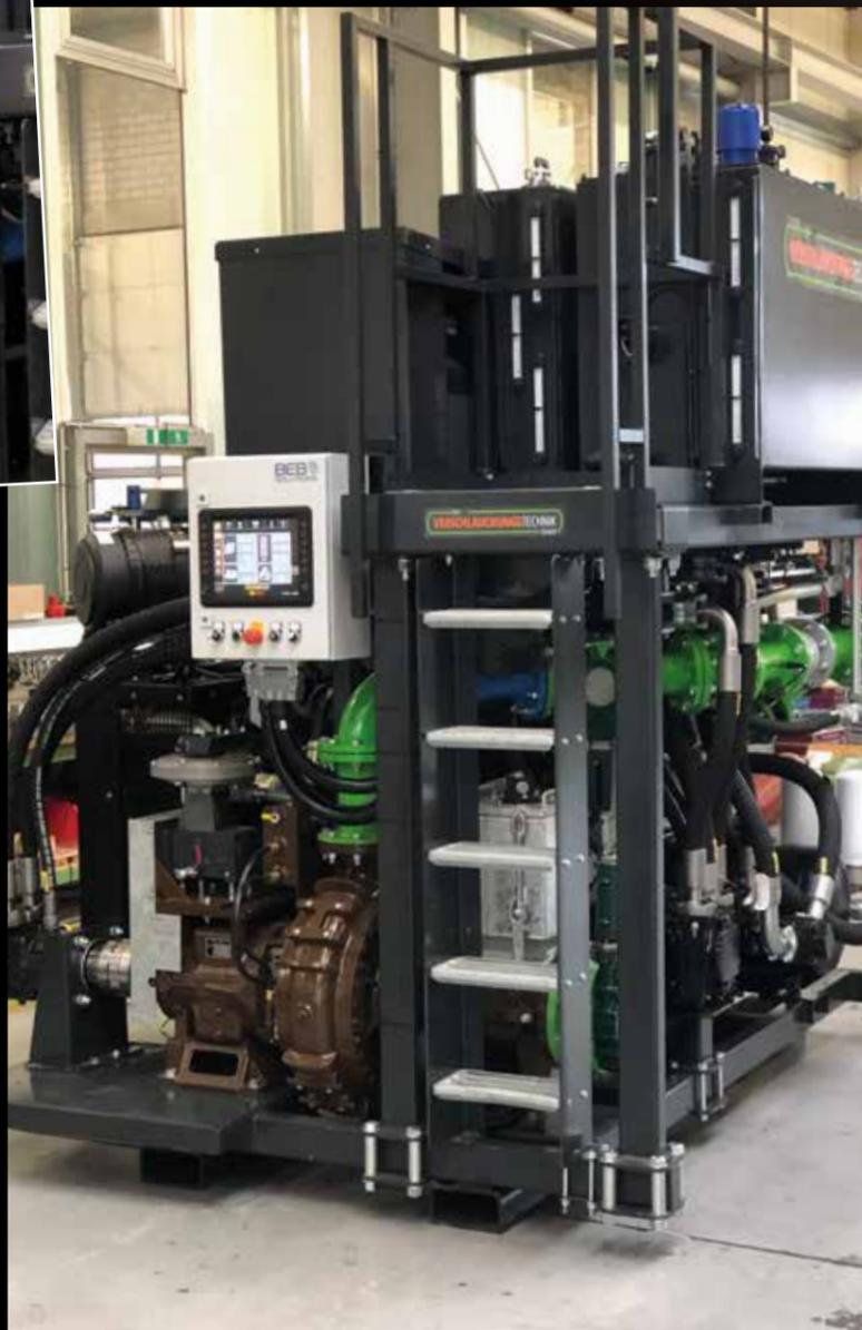
Auf dem 12"-Farb-Touchdisplay mit intuitiver Bedienoberfläche lassen sich vom Traktor aus alle Prozesse überwachen und steuern.
