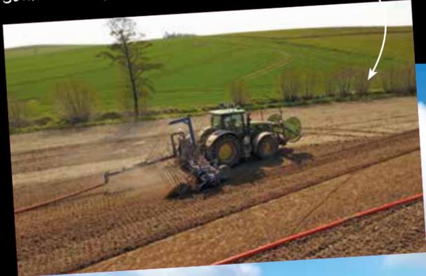
Güllecontainer mit vorne montierter Pumpstation (Zapfwellenantrieb). Schlauchhaspel BIG3 und Versorgungsschlauch CLASSIC VS NBR 152 in Schwarz.
