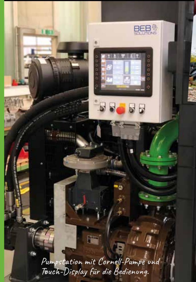
Pumpstation mit Cornell-Pumpe und Touch-Display für die Bedienung.
