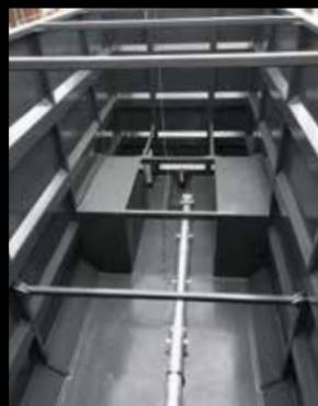
Gegen die Ablagerung von Güllebestandteilen kann eine Spülvorrichtung im Container genutzt werden.
