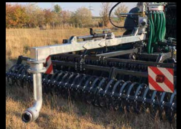
Scheibenegge SE V5 mit Dachringwalze und Wendearm für die Gülleverschlauchung.
